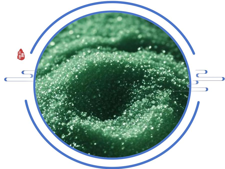
使用人造玻璃砂过滤取代传统石英砂滤以及UF膜过滤，不仅抑制细菌滋生、无结块、无空穴、保证过滤精度、实现长期稳定高效过滤效果，还降低海水预处理的运行费用。体现在（1）玻璃砂损耗低（年损耗小于1%），近乎无耗材，（2）系统根据压差自动反洗，无需要人工维护，（3）缩短系统流程、降低故障率。
