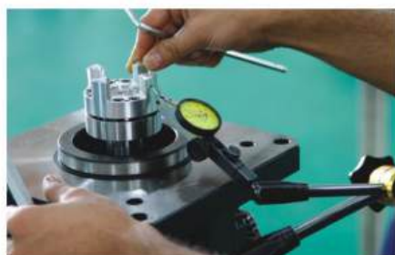
主軸聯軸器檢測 Spindle Coupling Inspection
