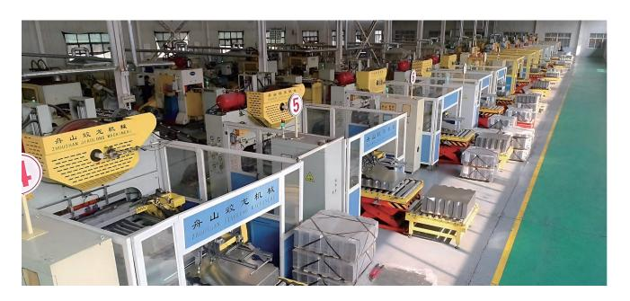
制盖车间现有国内先进的龙门冲制盖生产线18条,并配备光学检验设备、自动计数器和自动装袋机。 产品覆盖市场上所有规格的气雾罐顶、底盖产品和食品罐底盖产品,涉及气雾剂、发泡胶、卡式气、汽车护理品、日化品,及蕃茄酱、饮料、干果、罐头类食品等诸多领域。
