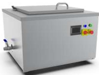
28-kHz- und 40-kHz-Ultraschalltanks mit Fassungsvermögen von 30 bis 75 Litern. Die Tanks verfügen über eine eingebaute elektrische Heizung von 1500W bis 2250W je nach Modell und eine Ultraschalleistung von 1000W. Alle Wannen sind mit einem 1/2"-Abfluss ausgestattet.
