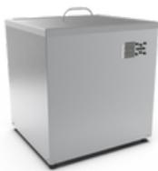
Cubas de ultrasonidos de 28kHz y 40kHz con capacidades de 10 litros y 30 litros. Las cubas llevan incorporado el sistema de calefacción eléctrico de entre 200W y 500W dependiendo de modelo, y potencias de ultrasonidos entre 200W y 400W. Todas las cubas vienen con desagüe de 3/8".
