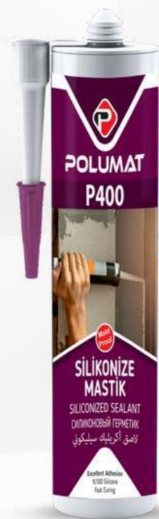
**SİLİKONİZE MASTİK** ; Tek bileşenli yüksek kaliteli, çatlamaya karşı dirençli, esnek silikonize mastik. %12,5 derz hareket kabiliyeti vardır. PVC ve alüminyum doğramaların montajında kullanılır. PVC, alüminyum, ahşap, beton gibi yapı malzemelerine mükemmel yapışma sağlar.
