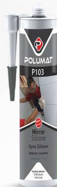
**AYNA SİLİKONU:** Nötr esaslı, ayna yapıştırma için kullanılan yüksek kaliteli yapıştırma silikonudur. Aynalarda kararmaya neden olmaz. Kokusuzdur. Korozyonu neden olmaz. Solvent içermez. %100 silikondur. Aynaları; fayans, çelik, alüminyum, ahşap, alçıpan ve beton gibi yüzeylere yapıştırma için uygundur.
